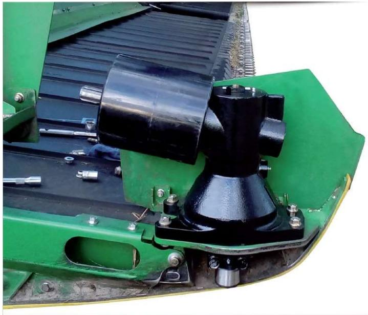
Colocar la brida del mando cardánico en el eje de salida de la caja de cuchilla. Si no logra el anclaje, al no poder mover la caja (por su posición lograda), retirar el eje cardánico en su otro extremo, que se encuentra sobre la caja escuadra, y girar hasta lograr el anclaje.
