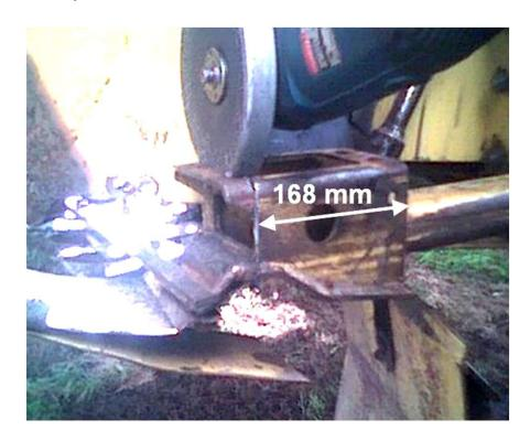
4 – Una vez realizados estos cortes, colocar la base sobre la plataforma resultante, y fijando los tornillos traseros (utilizando orificios originales) alineamos la base. Colocamos el postizo **TP-CA710** de modo que las aristas redondeadas queden hacia adelante, fijamos con los tornillos centrales de la base y punteamos con soldadora eléctrica en sus extremos.
