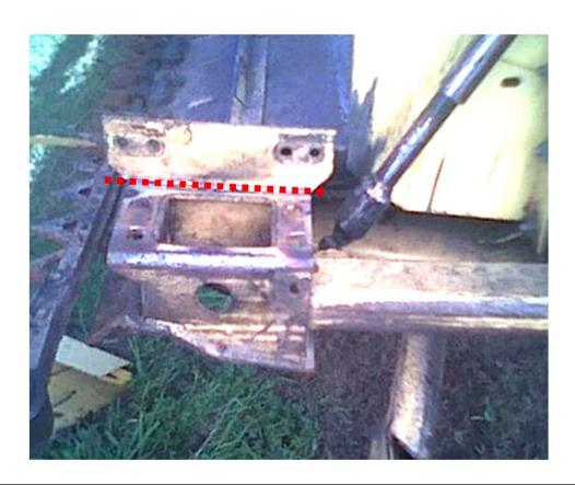
3 – Marcar el soporte original a 168,00 mm a partir de la parte trasera y cortar.
